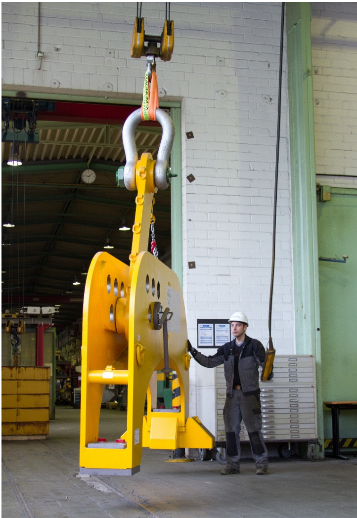
Abb. 1: Magnum-X short: Unverzichtbar bei kurzen Hubhöhen und äußerst kompakt durch Verwendung von Hochleistungsfasern.
