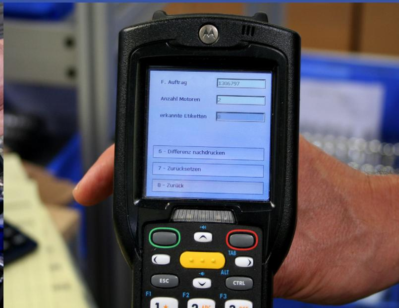
Durch das Erfassen des Barcodes zu Fertigungsbeginn mit einem mobilen Datenerfassungsgerät wird gleichzeitig der Druck eines kleinformatigen Motoridentifikationsetiketts angestoßen, welches mit Hilfe eines Applikators auf das Lagerschild des zu produzierenden Motors aufgebracht wird.
