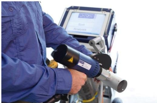
Die Messungen werden mit einer einfach zu handhabenden Sonde durchgeführt. Der Legierungsgrad und die komplette chemische Zusammensetzung erscheinen innerhalb von wenigen Sekunden auf dem integrierten Touch-Bildschirm. Die Metalllegierung wird automatisch identifiziert, und jede Überschreitung von benutzerspezifischen Grenzen wird angezeigt. Die leichtgewichtige Sonde ist ergonomisch gestaltet und liegt ausbalanciert und komfortabel in
