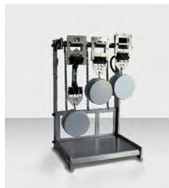
Nach dem Ausstanzen kann die Stabprobe mit dem Hot Set Test in einem Wärmeschrank geprüft werden.
