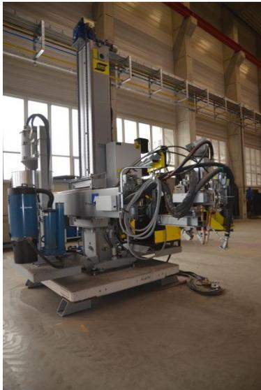
*Das neue Schweißverfahren wird nicht manuell, sondern mithilfe dieser Unterpulveranlage durchgeführt.*
