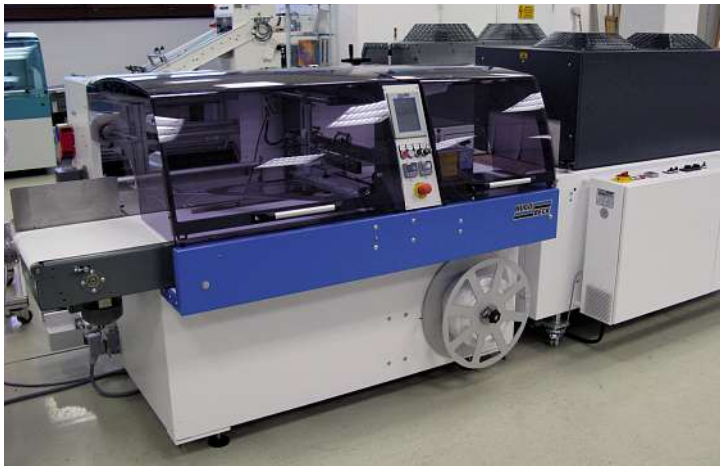
WVD kann ab Oktober 2012 mit der Folienverpackungsanlage flexo und dem Schrumpftunnel SLB 5012/25 perfekte Einschweißungen vornehmen.
