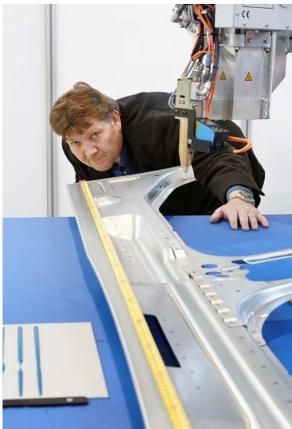
*SCA bietet hochpräzise Systeme an, die den Kleb- oder Dichtstoff zur richtigen Zeit an der richtigen Stelle mit der richtigen Dichte aufbringen – und auch kritischen Blicken standhalten.*
