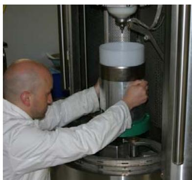
**Bild 3:** Für das Recycling von Karbonfaser verstärkten Kunststoffen gibt es bislang noch keine wirtschaftliche Lösung. Forscher am Fraunhofer IBP arbeiten an der Weiterentwicklung des Verfahrens der elektrodynamischen Fragmentierung.
