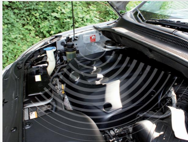
**Ultraschall Marderabwehrgerät mit Hochspannung**
