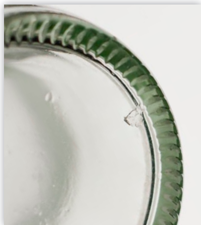
Der HEUFT InLine IX identifiziert u.a. Glassplitter, Gewinderisse und Muschelbrüche.
