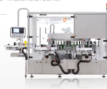
Der HEUFT InLine IX identifiziert u.a. Glassplitter, Gewinderisse und Muschelbrüche.
