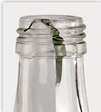
Der HEUFT InLine IX identifiziert u.a. Glassplitter, Gewinderisse und Muschelbrüche.
