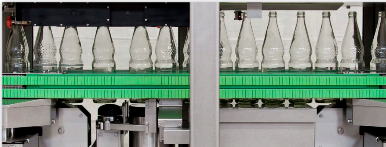
Servogesteuerte Transportriemen richten die Flaschen exakt aus.
