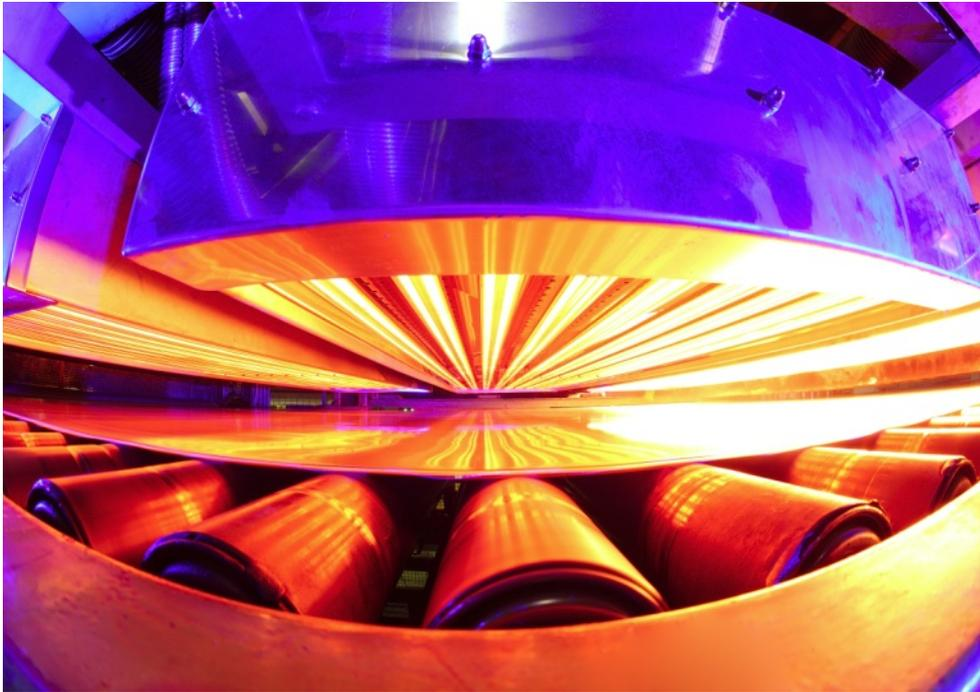
Carbon Infrarot-Strahler erwärmen Kunststoffmaterial vor dem Prägen schnell und homogen.
