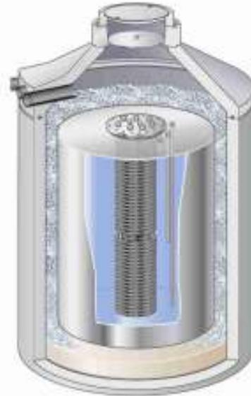
Wärmespeicher sind gerade beim Einsatz von regenerativen Energien erforderlich. In allen Pufferspeichern aus dem Hause Mall wird zwischen Außen- und Innenbehälter zur dauerhaften Isolierung das druckfeste und feuchtigkeitsresistente Blähglasgranulat von Poraver eingesetzt. Bis zu 25 cm dick sind die Isolierschichten aus Recyclingglas.
