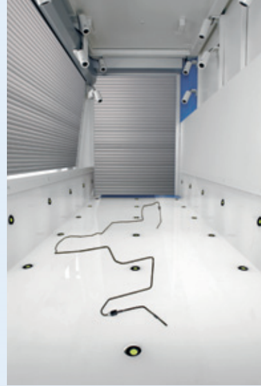
Auch lange und dünne Rohre werden ohne Aufspannung gemessen.
