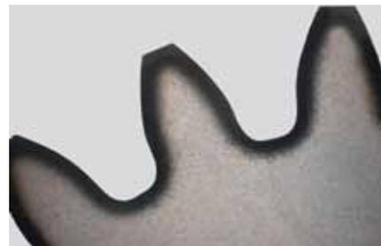
Kennzeichnend für die Haltbarkeit ist die Härte eines Zahnrads an der Oberfläche, im Schliffbild durch die dunklere Farbe visualisiert. Speziell für moderne Vielgang-Getriebe mit sieben oder acht Gängen gilt: Je härter je lieber.
