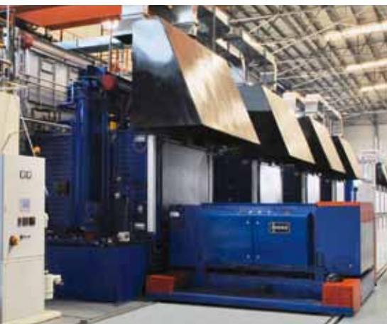
**Eine Ofenanlage von Ipsen wird von einer präzisen Prozesssteuerung geführt, die Qualitätsprozesse nicht nur einfach ansteuert, sondern gleichfalls präzise dokumentiert.**
