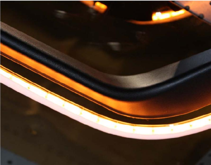
QRC® Infrarot-Strahler besitzen einen Nanoreflektor aus Quarzmaterial und können exakt einem Werkstück nachgeformt werden.
