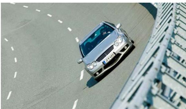
Ein kurzer Bremsweg auf nasser Fahrbahn kann einen Unfall verhindern, denn die Bremswege sind bei Regen länger als viele Autofahrer glauben. Nokian testet das Bremsvermögen auf vier verschiedenen Straßenbelägen: deutscher, also glatter, Asphalt, Beton, rauher, nordischer Asphalt und grober
