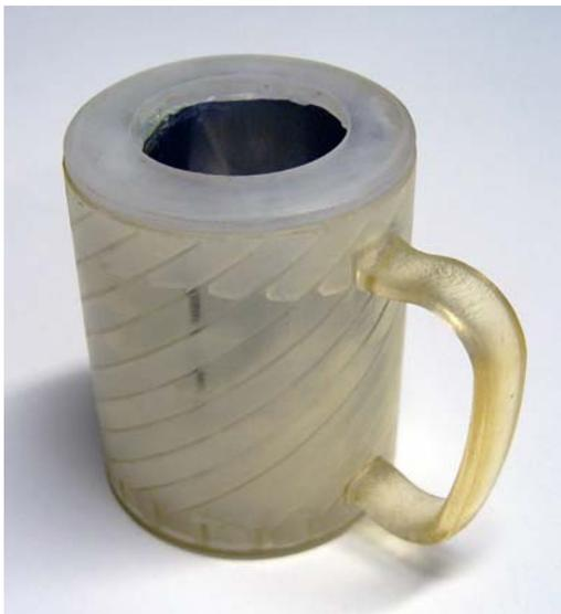
**Bild:** Prototyp der PCM-Tasse des Fraunhofer IBP für die Validierung der Untersuchungen.
