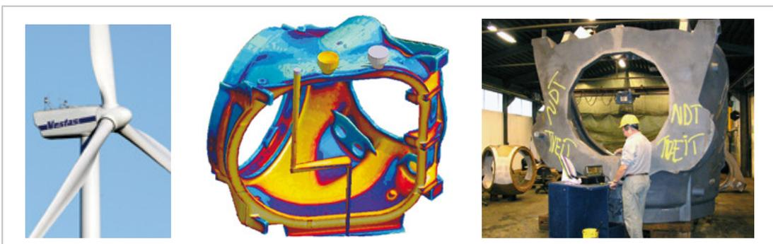
Die Nabe ist ein wichtiges Gussteil in Windkraftanlagen und kann ein Gewicht von mehreren Tonnen erreichen. Die Abbildung zeigt die MAGMASOFT®-Simulation des Erstarrungsprozesses für eine in Gusseisen gefertigte Nabe (Bilder mit freundlicher Genehmigung von Vestas Casting Group AS, Norwegen).
