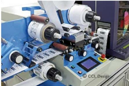
Das ELTEX 7500 Schilderdruck- und Laminiersystem druckt, laminiert und stanzt große Etikettenserien in einem Arbeitsgang.
