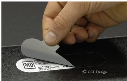
Der Lackerschutz wird nach dem Lackiervorgang mit dem Lack vom Werkstück gezogen. Das Etikett ist mit dem Dauerschutzlaminat in die Lackschicht unterwanderungssicher eingebettet.
